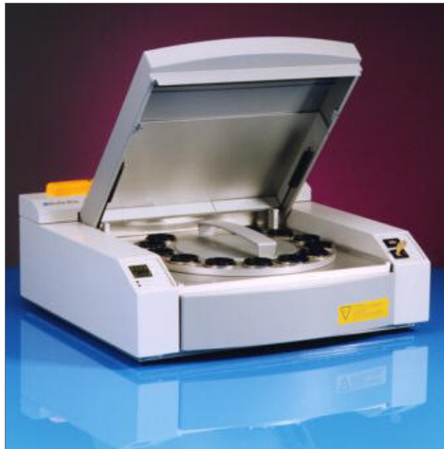
Фото 2. Настольный спектрометр MiniPal 4 фирмы PHILIPS Analytical B.V
